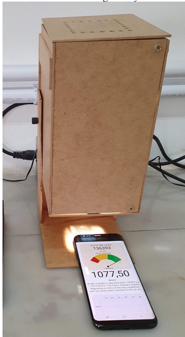
Figura 34 - Calibração do simulador solar por meio do aplicativo Photometer Pro utilizando o sensor de um Samsung Galaxy S8 Plus .
