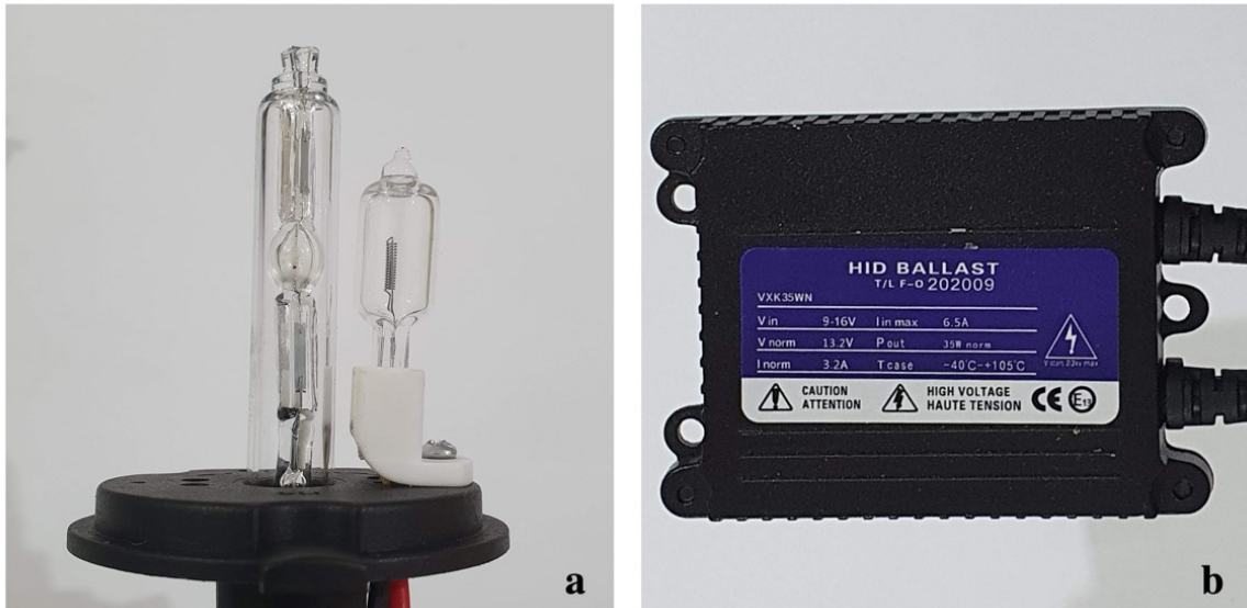
Figura 11 - Soquete contendo as lâmpadas de xenônio e halogênio (a) ao lado do reator (b)
