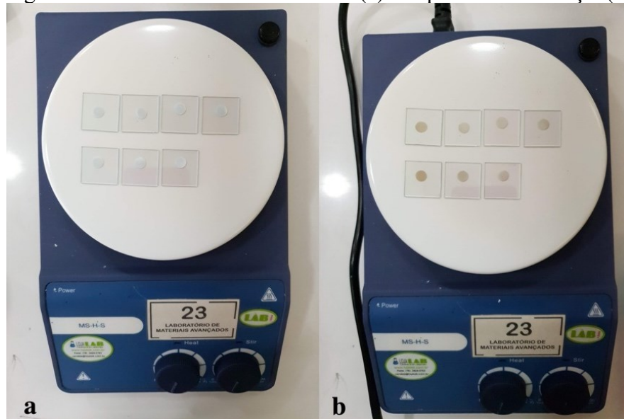
Figura 25 - Substratos com TiO 2 antes (a) e depois da sinterização(b)
