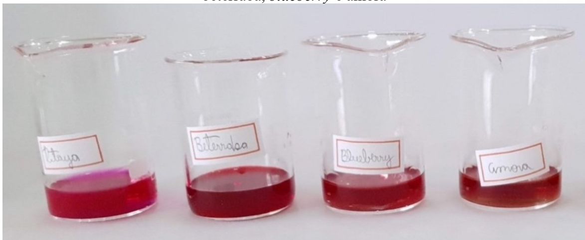
Figura 26 - Sensibilização das DSSC's por meio de submersão nos estratos de pitaya , beterraba , blueberry e amora
