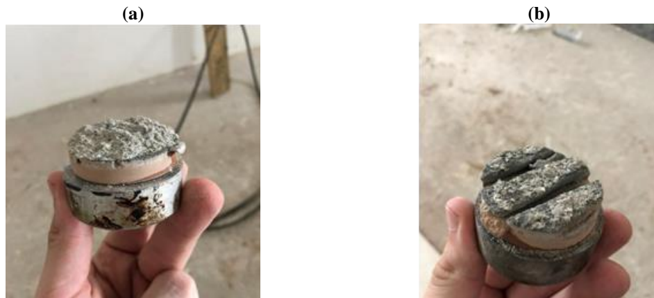
Figura 9 - Ruptura de CP: (a) Ruptura S, (b) Ruptura S/A.
