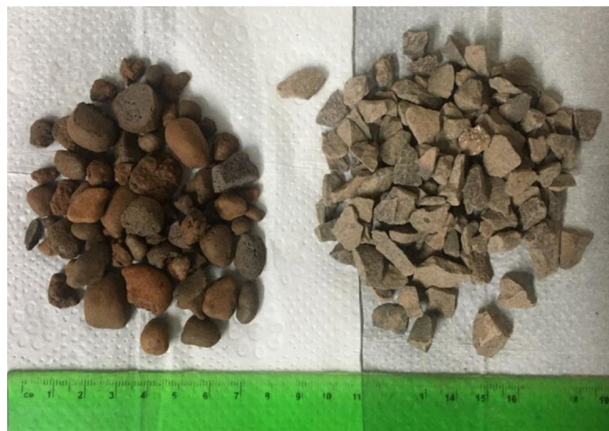
Figura 2: Comparação entre argila expandida e brita. Fonte: Elaborado pelos autores (2020).
