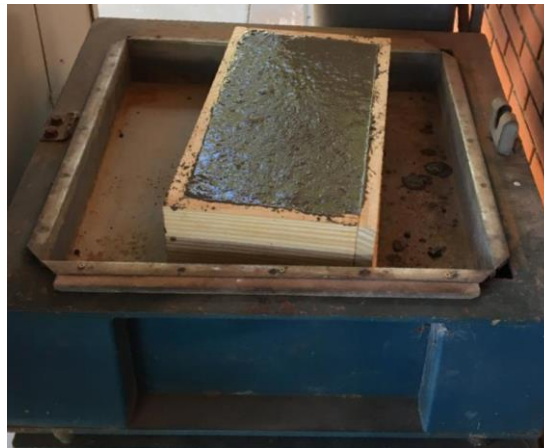
Figura 3: Adensamento do concreto fresco. Fonte: Elaborado pelos autores (2020).
