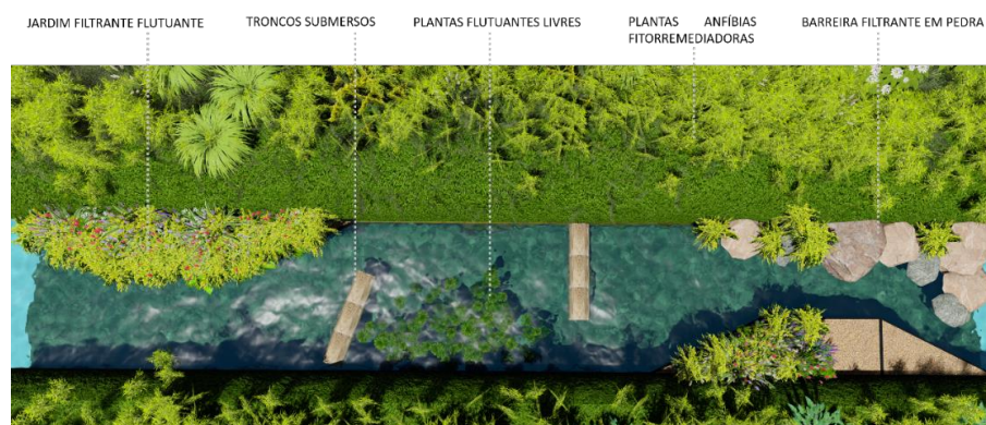
Figura 8: Medidas remediadoras propostas. Fonte: primeiro autor.
