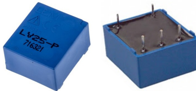
Figura 5.6 – Sensor de tensão do V25-P/SP5
