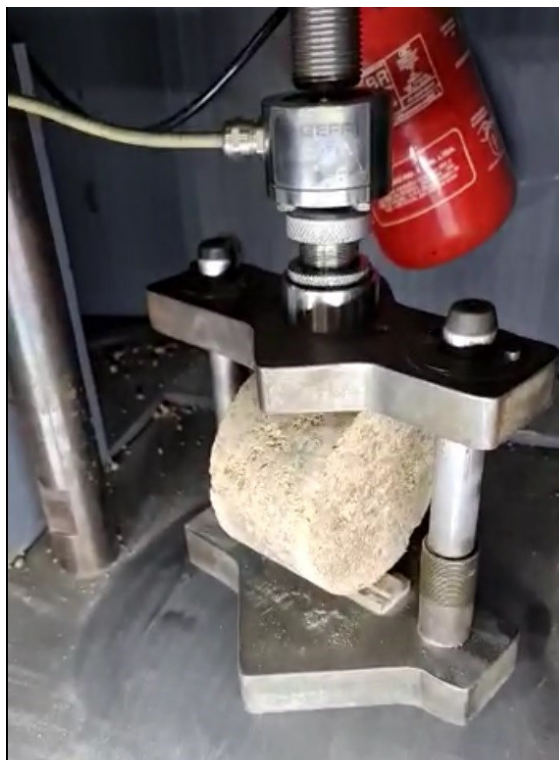
Figura 38: Ensaio de fadiga em andamento após a remoção do LVDT
