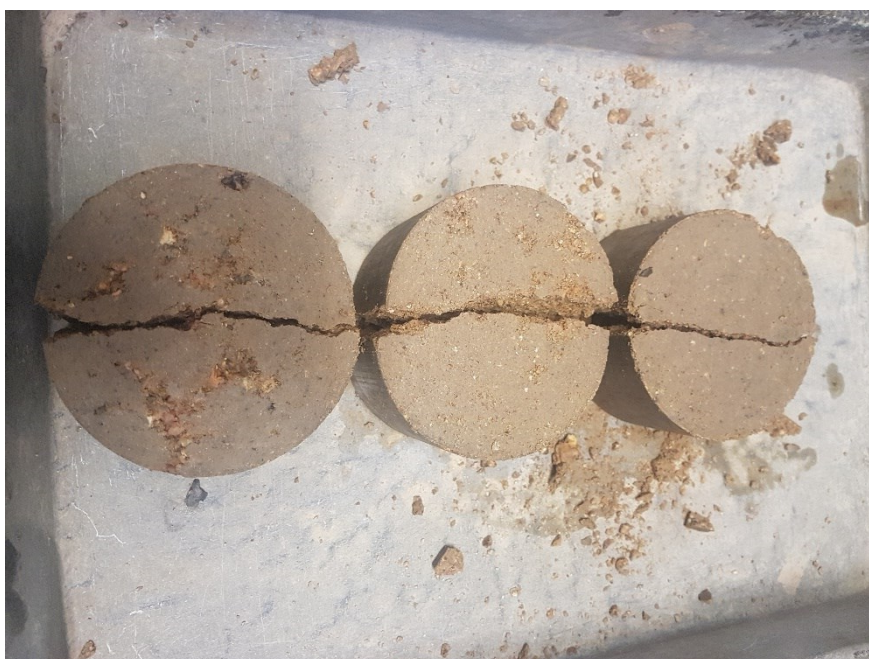
Figura 36: Corpos de prova após realização do ensaio de RTCD
