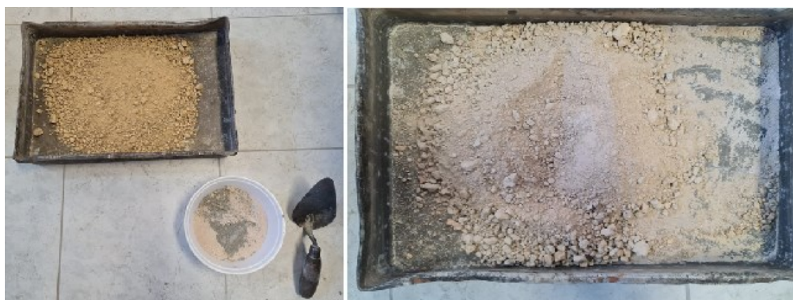
Figura 32: Solo natural e aglomerantes (esquerda) e mistura homogeneizada (direita)
