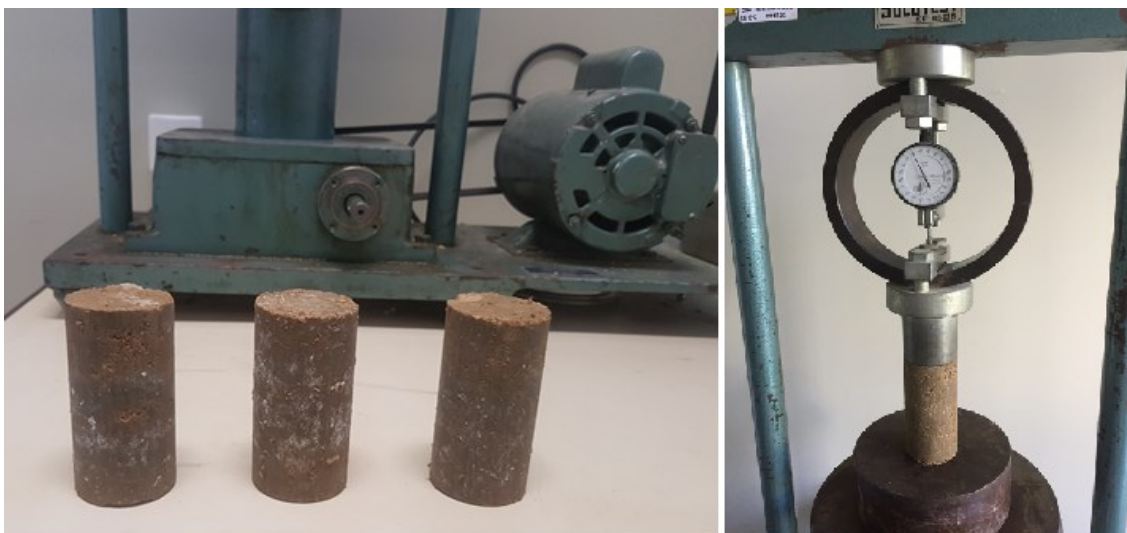
Figura 35: Corpos de prova (esquerda) e ensaio de RCS (direita)
