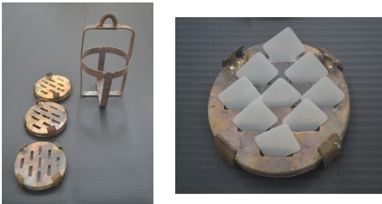
Figura 4 - Recipiente metálico usado para o apoio das amostras durante a têmpera.
