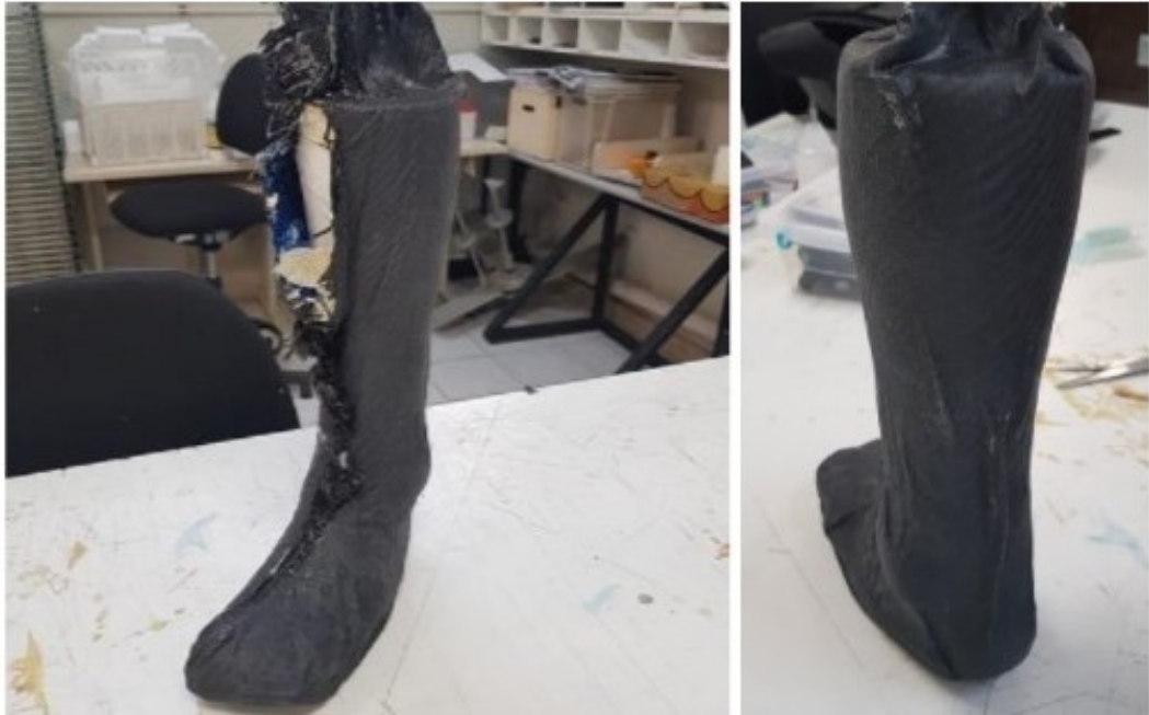
Figura 33 - Órtese pós cura separada do kit infusão
