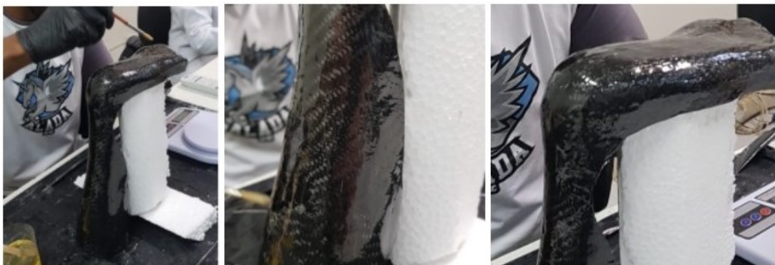
Figura 36 - Primeiro acabamento externo com resina epóxi
