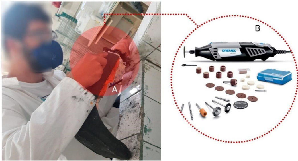
Figura 34 - Corte e separação da órtese de seu molde.
