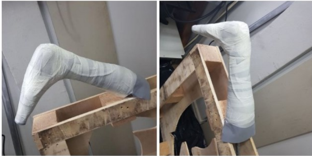
Figura 26 - Molde da órtese já impregnada de desmoldante PVA
