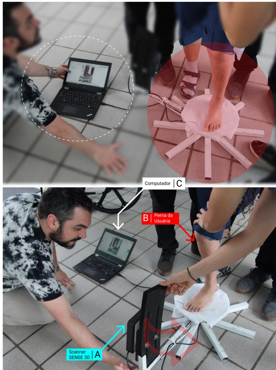
Figura 16 - Escaneamento da usuária Scanner 3D + base de escaneamento.
