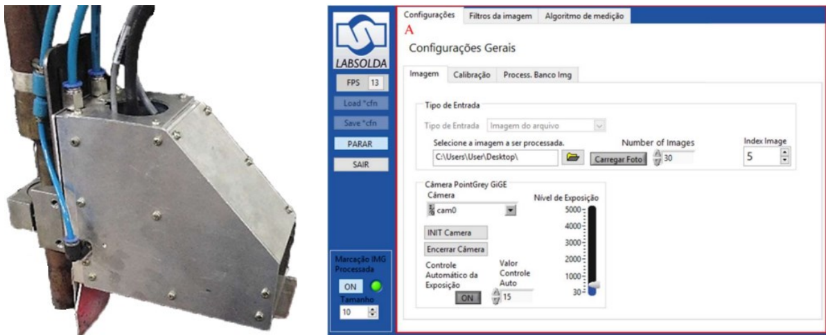
Figura 6.4 – STL4: Sensor LABSOLDA e software próprio desenvolvido em LabVIEW .
