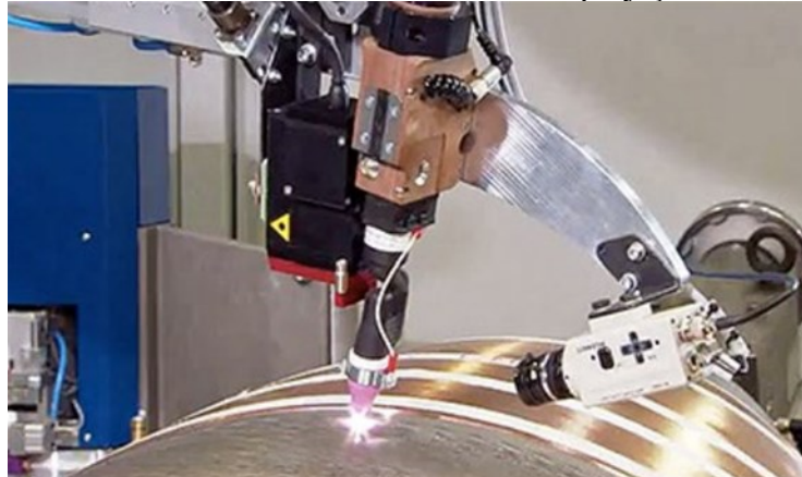
Figura 3.20 – Sistema Meta Scout , STL com projeção de 5 linhas.
