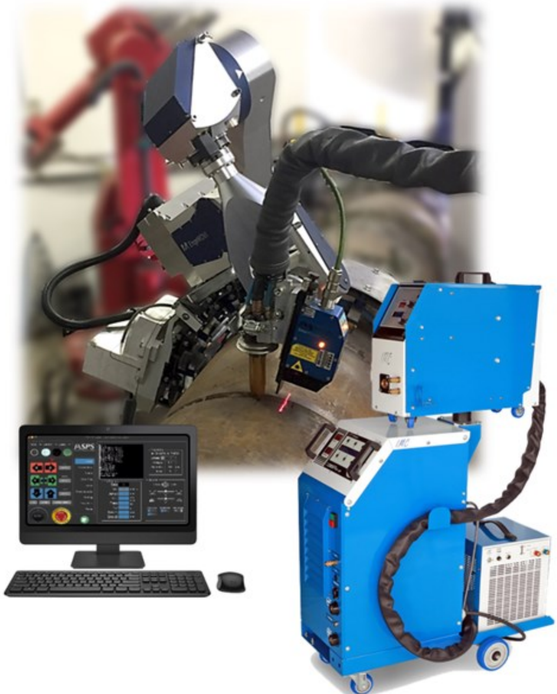
Figura 2.12 – Sistema de soldagem adaptativa desenvolvido por LABSOLDA e parceiros.
