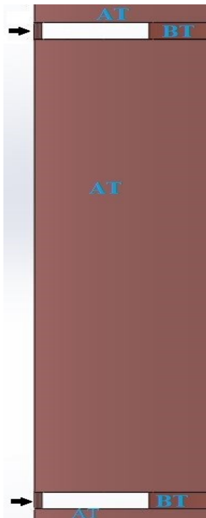
Figura B.7.3: Detalhe da ligação série entre as bobinas AT de uma fase
