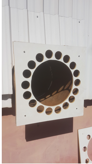
Figura 8 – Placa de restrição de área (50%) instalada na saída do duto
