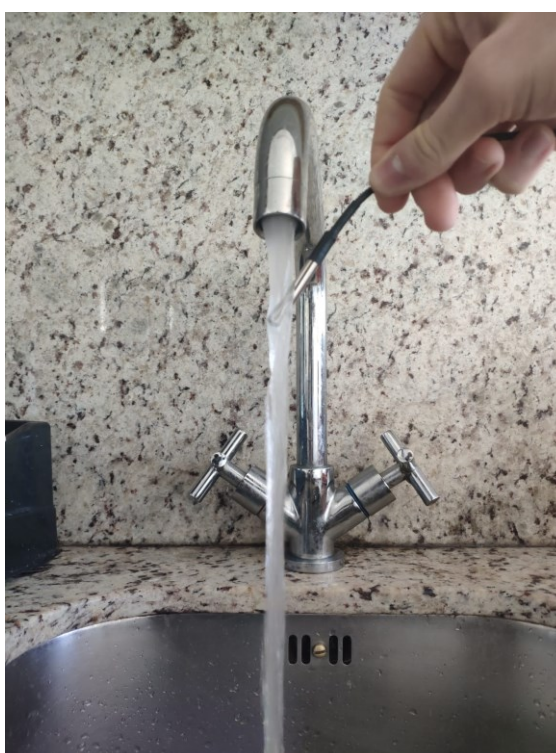
Figura 3.4 – Medição da temperatura da água na saída do aparelho sanitário por meio do sensor DS18B20.
