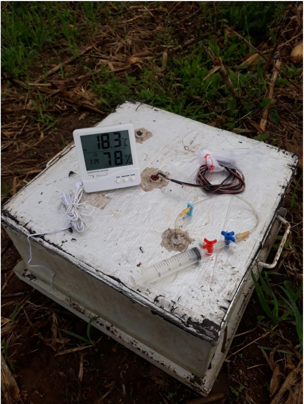
Figura 10 - Câmara estática com seringa e termo-higrômetro acoplados para coleta de amostras gasosas.
