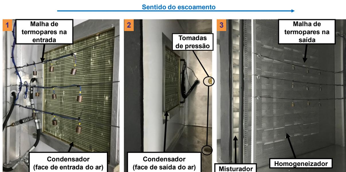
Figura 3.6 – Seção de testes do condensador
