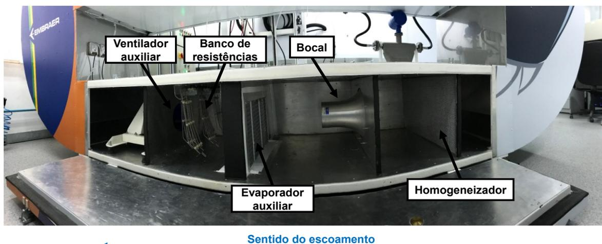
Figura 3.7 – Ramal inferior do túnel do condensador.
