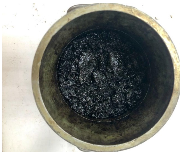
Figura 7 - Inserção da mistura asfáltica no interior dos moldes.
