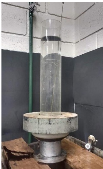
Figura 16 - Drenômetro utilizado durante os ensaios sobre corpos de prova Marshall.
