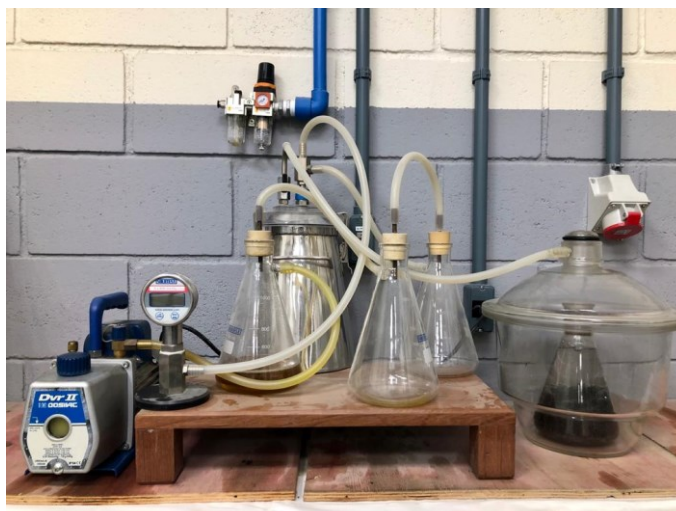
Figura 14 - Equipamento utilizado durante o ensaio de MVR.
