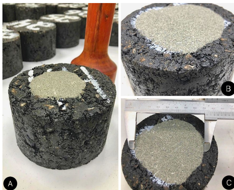
Figura 15 - Execução do ensaio de mancha de areia.
