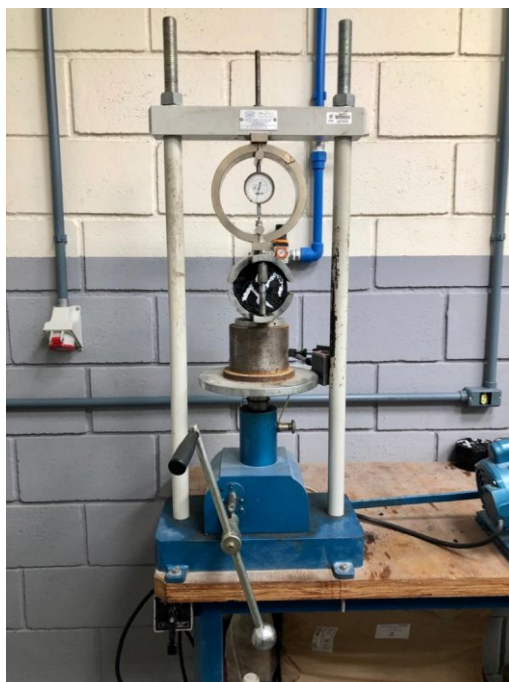
Figura 11 - Corpo de prova na prensa hidráulica para ruptura.
