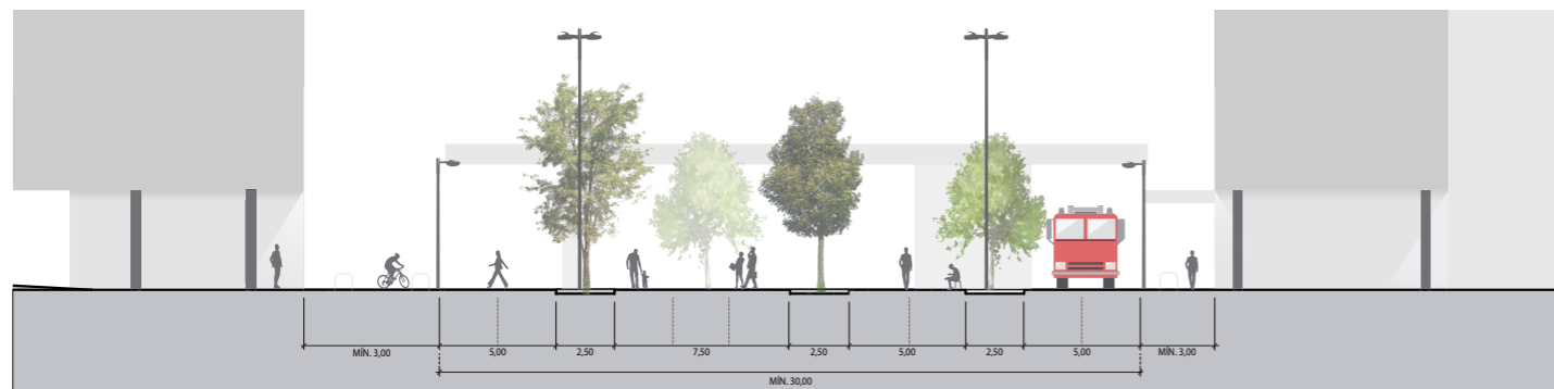
Figura 23 - Seção transversal e modulação da Praça Central
