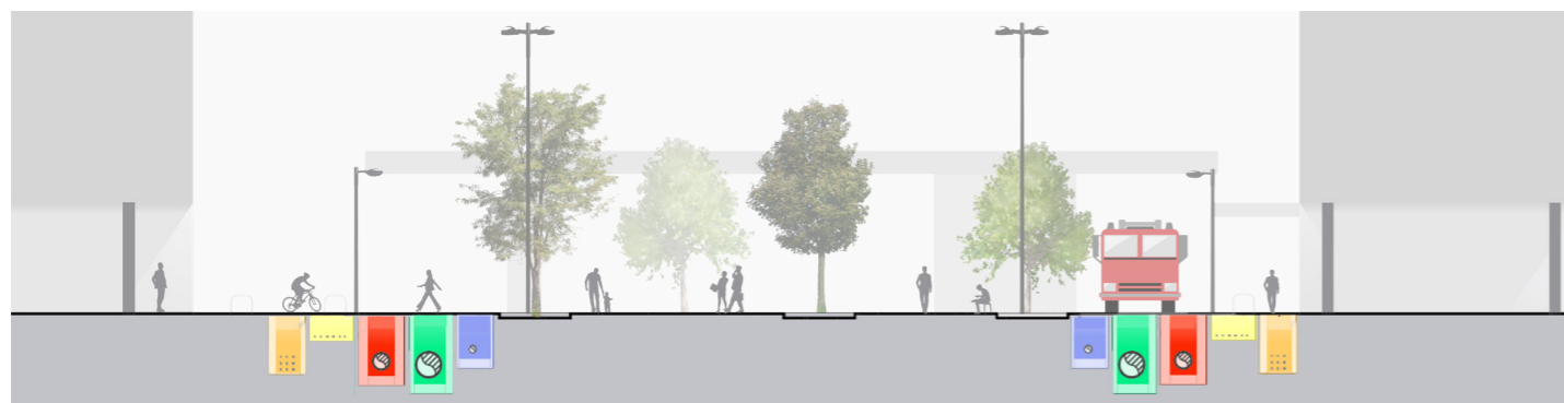
Figura 36 - Seção transversal da Praça Central e localização das redes de infraestrutura Fonte - Elaborado pelos autores
