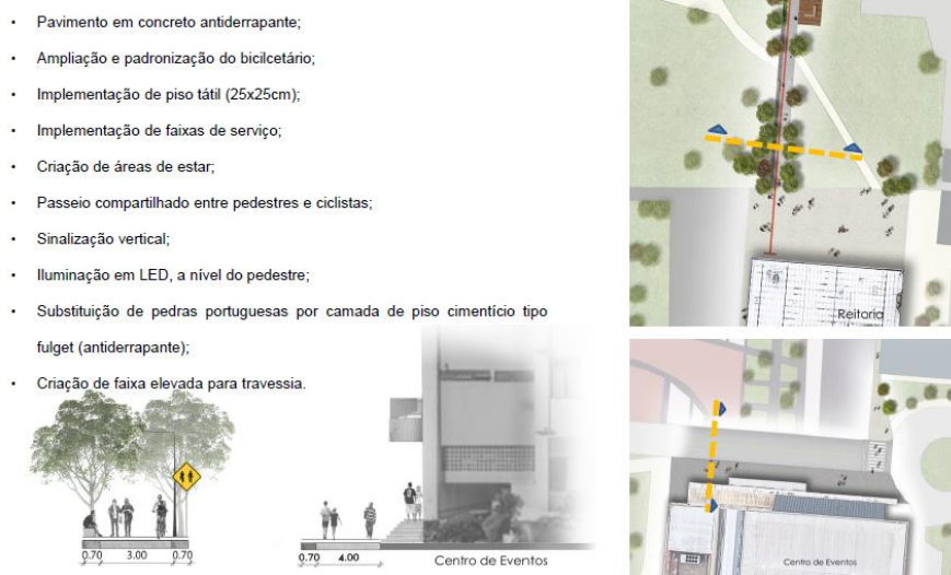
Figura 23 – Projeto Rotas Acessíveis – Piloto Diretrizes de implantação - Exemplo
