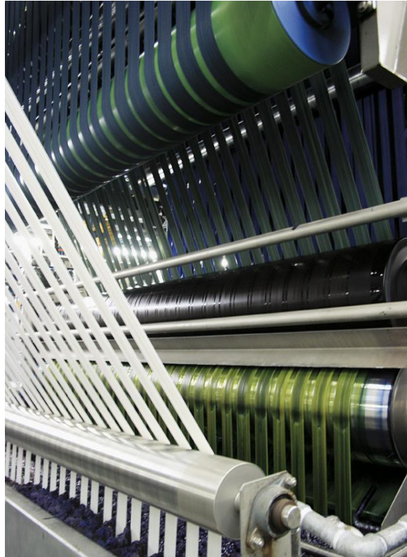
Figura 8 – Processo de tingimento por corda
