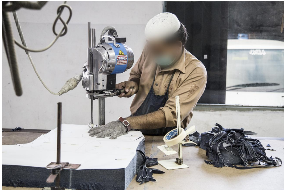
Figura 10 – Processo de corte do Denim com equipamento manual
