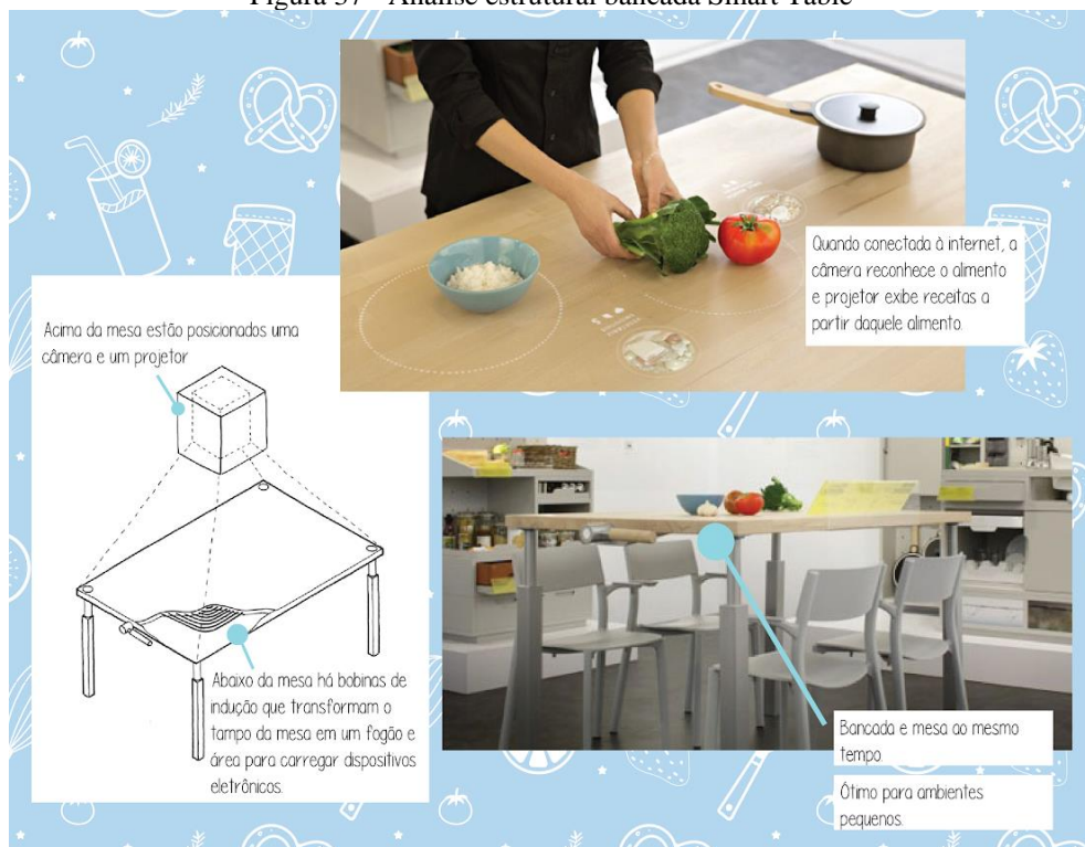
Figura 37 - Análise estrutural bancada Smart Table
