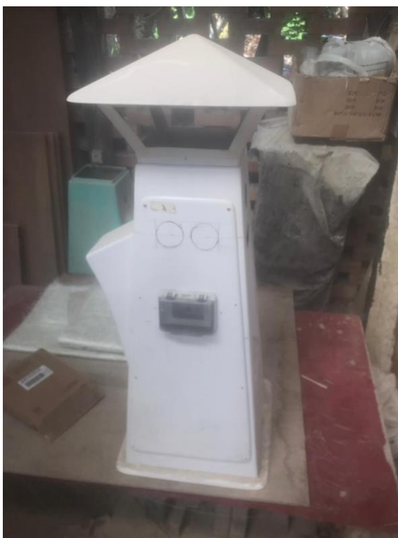
Figura 2 – Torre náutica sendo montada e seus acessórios sendo embutidos
