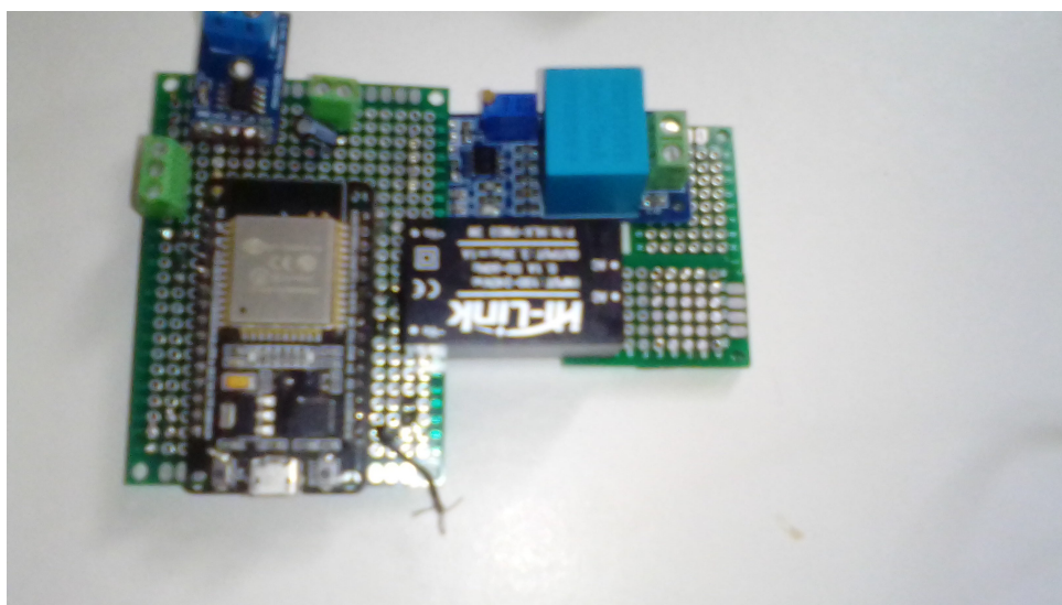
Figura 27 – Montagem final do sistema de monitoramento e aquisição de dados.
