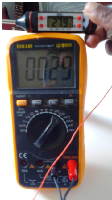
Figura 17 – Termômetro culinário digital e sensor do tipo K (multímetro).
