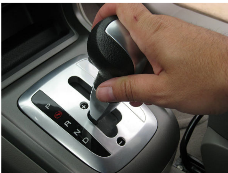
Figura 2 – Alavanca de câmbio automatizado com opção de troca de marcha manual.
