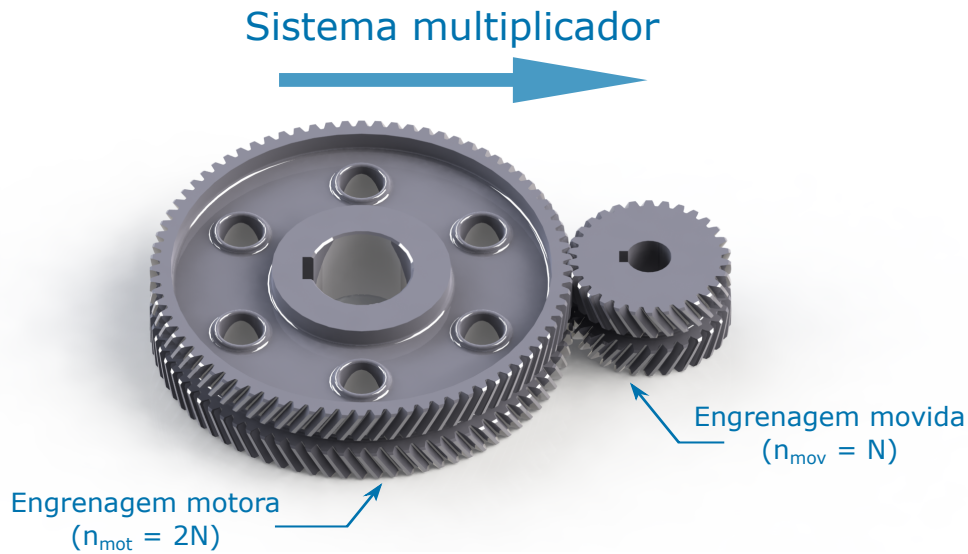
Figura 4 – Par de engrenagens em sistema multiplicador.
