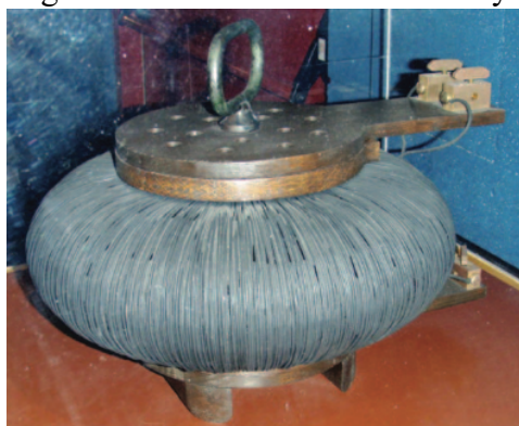
Figura 2 - Transformador de Bláthy.
