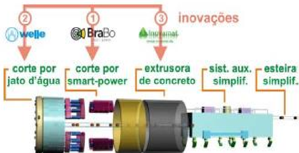
Figura 3.28. As três inovações da tuneladora
