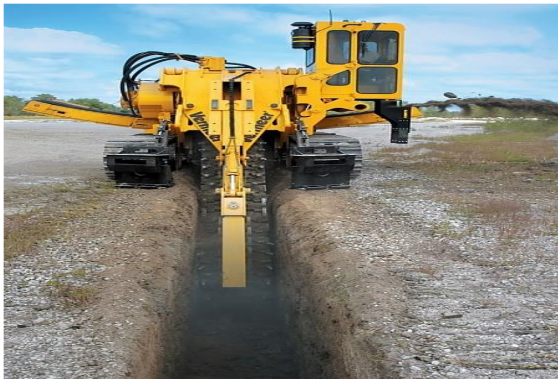
Figura 2.24. Valetadeira sobre esteiras com lança de escavação (grande dimensão).
