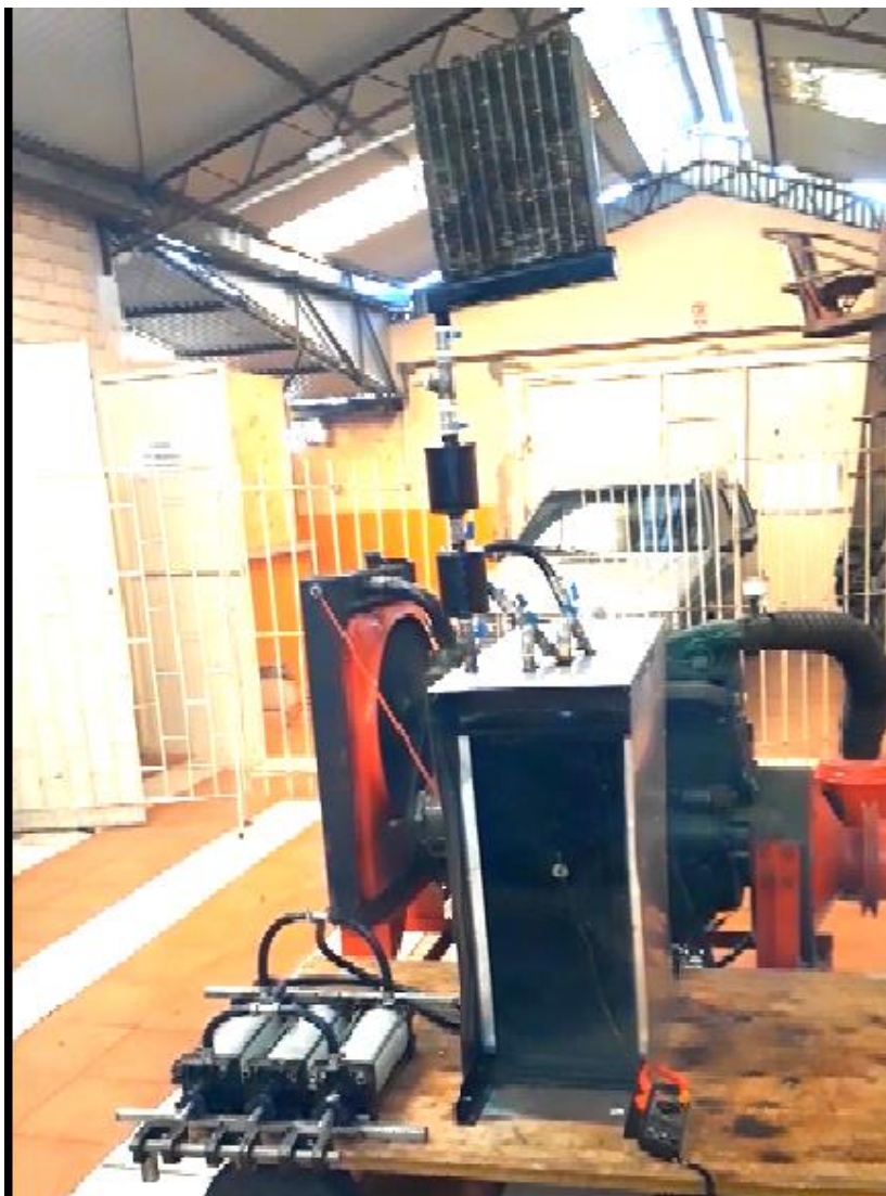
Figura 4.7: Equipamento de cogeração completo acoplado ao escapamento do motor a diesel. O condensador encontra-se na posição superior central da imagem.
