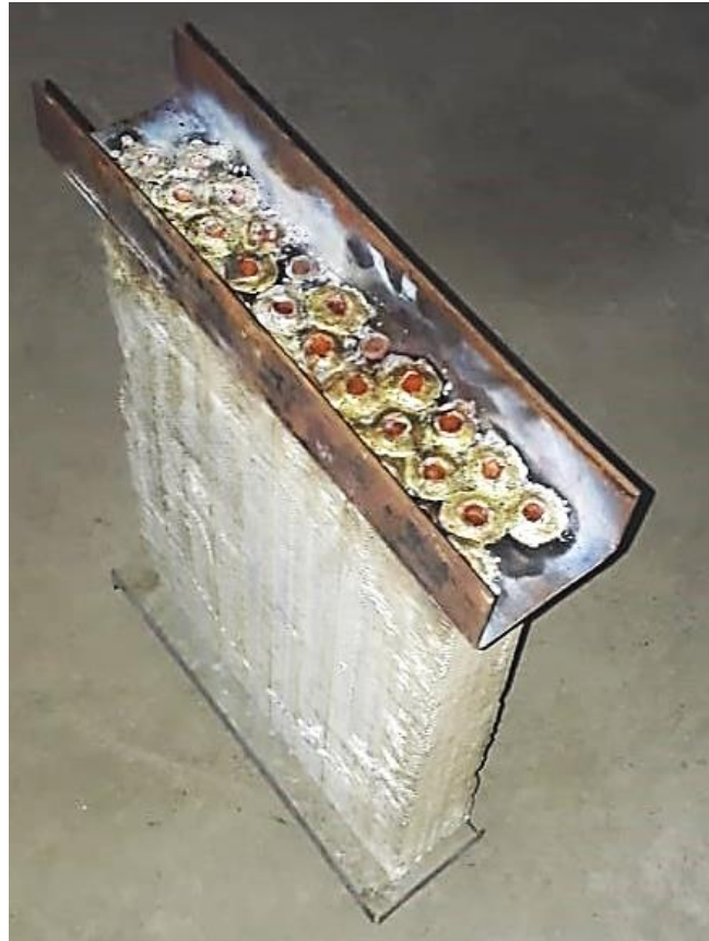
Figura 4.4: Montagem dos trocadores de calor.
