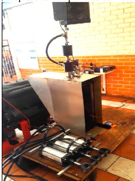
Figura 4.6: Conexão dos cilindros e a unidade recuperadora de vapor com o conjunto coletor de calor, acoplado ao escapamento do motor a diesel.
