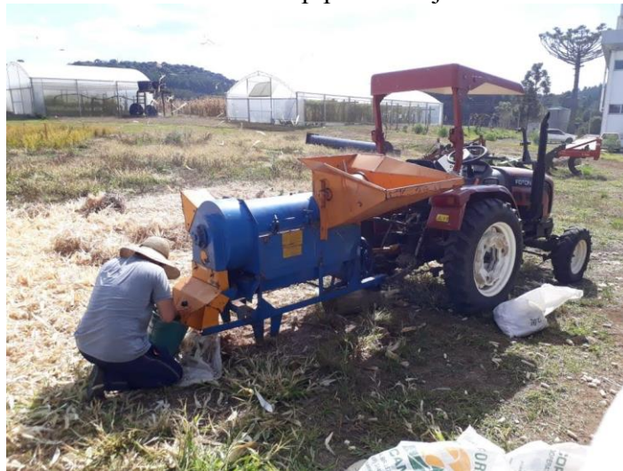
Figura 4 - Debulha das culturas de milho-pipoca e feijão de forma mecanizada.
