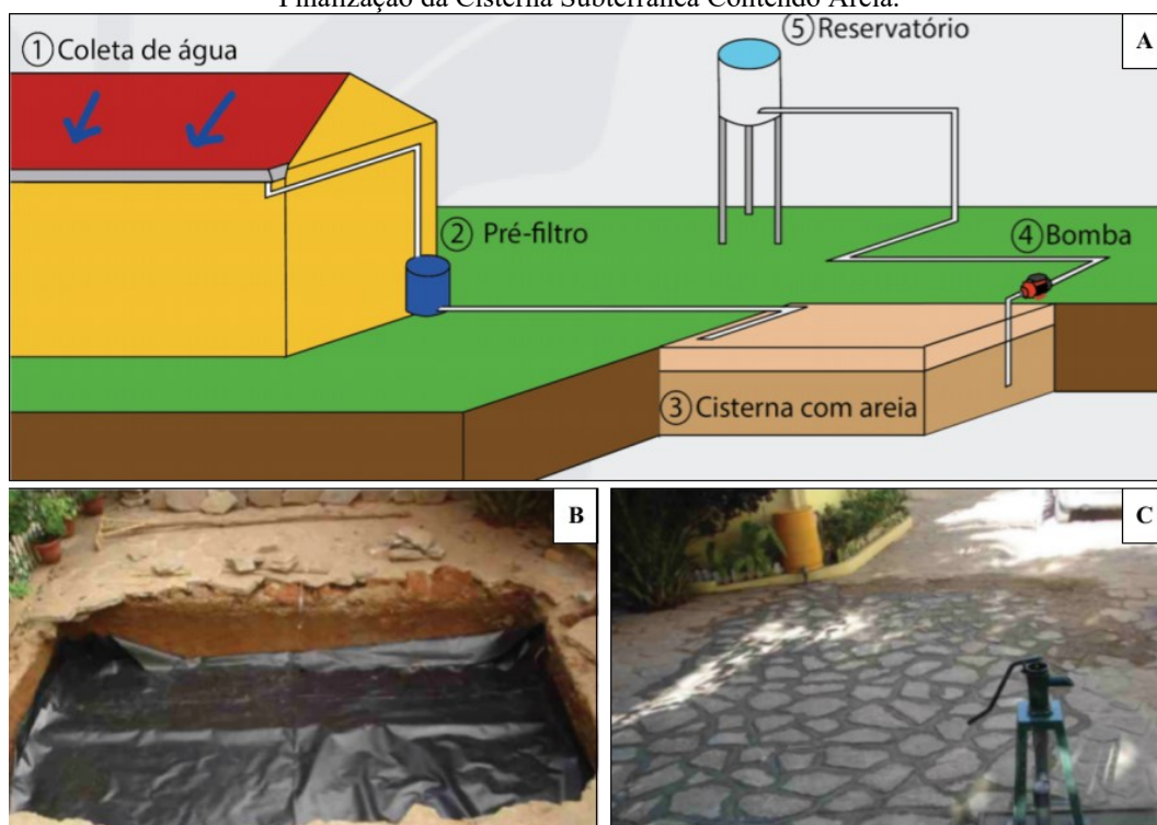
Figura 7 - Cisterna Subterrânea Contendo Areia: (A) Esquema; (B) Fotos da instalação com geomembrana; (C) Finalização da Cisterna Subterrânea Contendo Areia.
