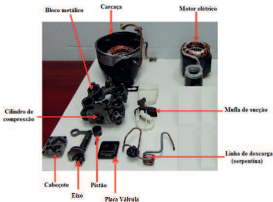
Figura 20 – Componentes do compressor hermético
