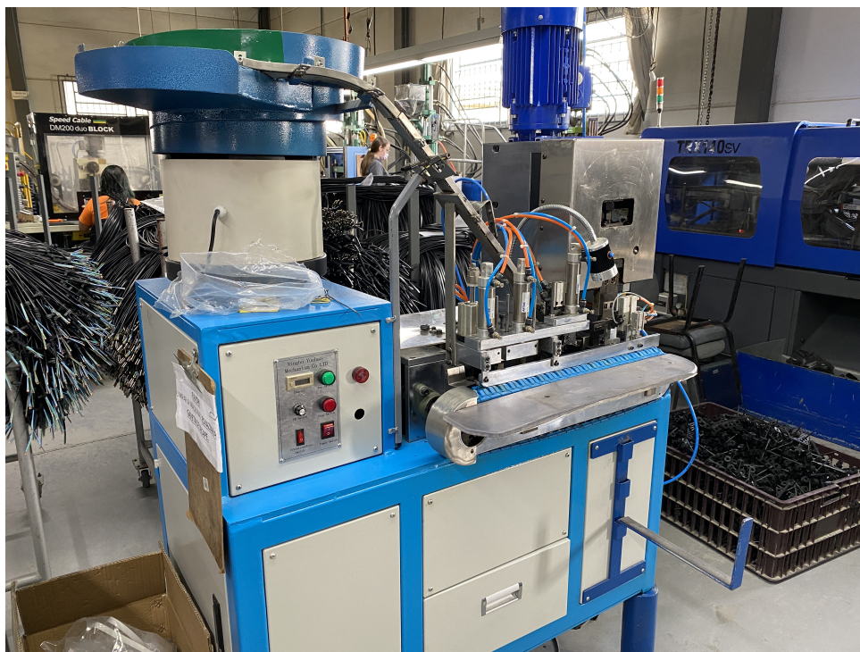
Figura 2 – Exemplo de maquinário para o processo de aplicação de pino, já com separador, e crimpagem. Fonte: Elaborada pelo autor.
