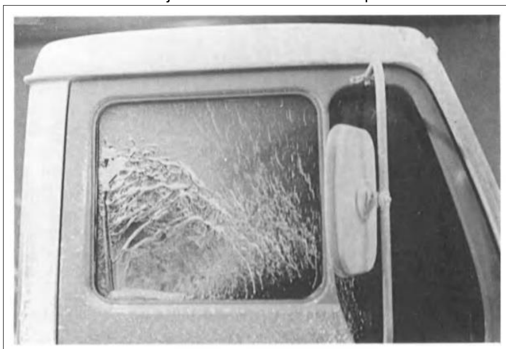
Figura 3: Janela lateral suja devido à influência do espelho retrovisor externo.
