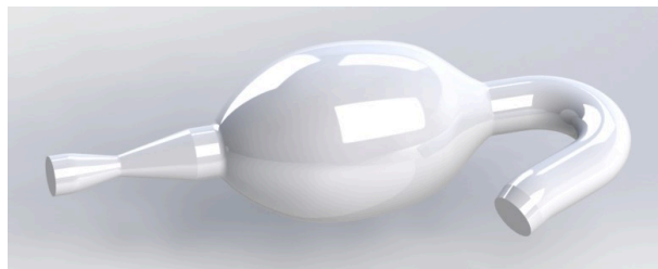
Figura 16 – Sistema 2: variação dos ângulos dos bocais do restritor
