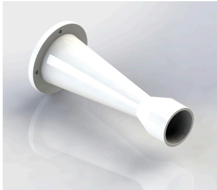
Figura 5 – Restritor utilizado no sistema original
