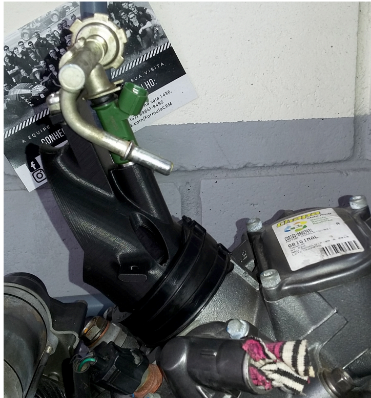
Figura 8 – Tryout construído para verificar posicionamento do injetor no sistema original
