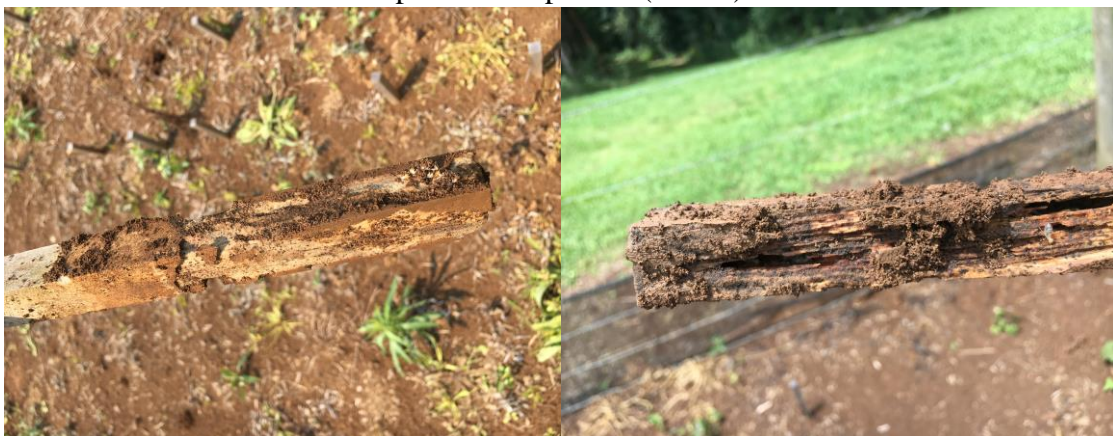
Figura 16 – Ataque superficial de cupins no tempo 225 (esquerda) e ataque severo de cupins no tempo 315 (direita).
