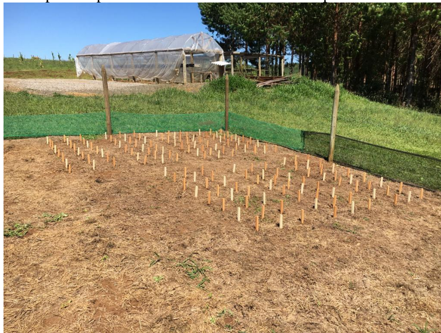
Figura 10 – Campo de Apodrecimento instalado na Área Experimental Florestal (UFSC).
