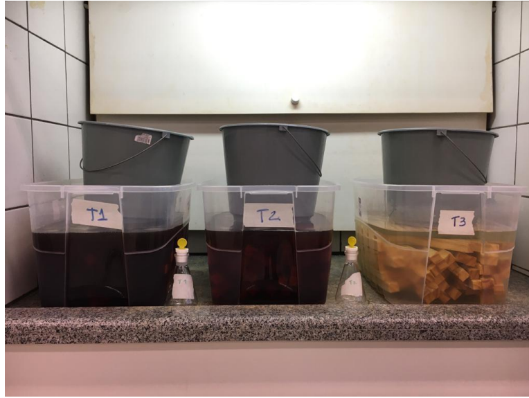
Figura 8 – Corpos de prova imersos nas soluções de tratamento.
