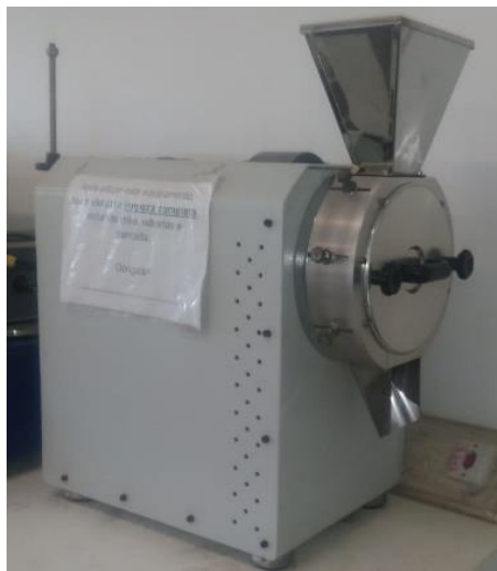
Figura 6 – Moinho de facas do tipo Wiley.
