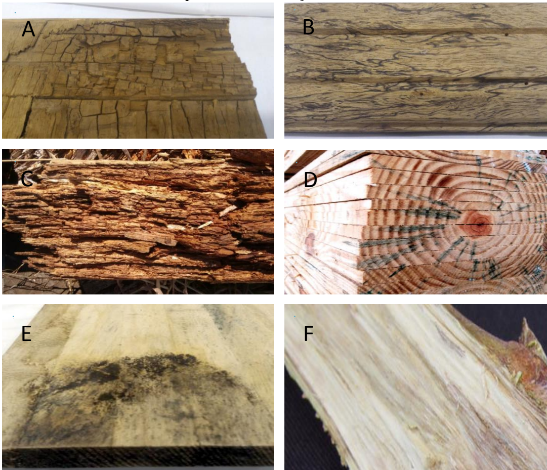
Figura 1 – Sintomas em diferentes madeiras atacadas por organismos xilófagos. A) Aspecto da madeira atacada por podridão parda; B) Ataque de podridão branca separada da madeira não atacada pela típica linha escura; C) Madeira atacada por fungo de podridão mole; D) Ataque de fungos manchadores na madeira; E) Presença de bolor causado por fungos emboloradores; F) Manchas ao longo do lenho provenientes da ação de bactérias.
