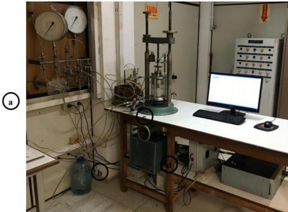
Figura 17: Equipamento para ensaio triaxial (a) Sistema hidráulico (b) câmara triaxial (c) Sistema de aplicação de deslocamento vertical (d) Sistema de aquisição de dados
