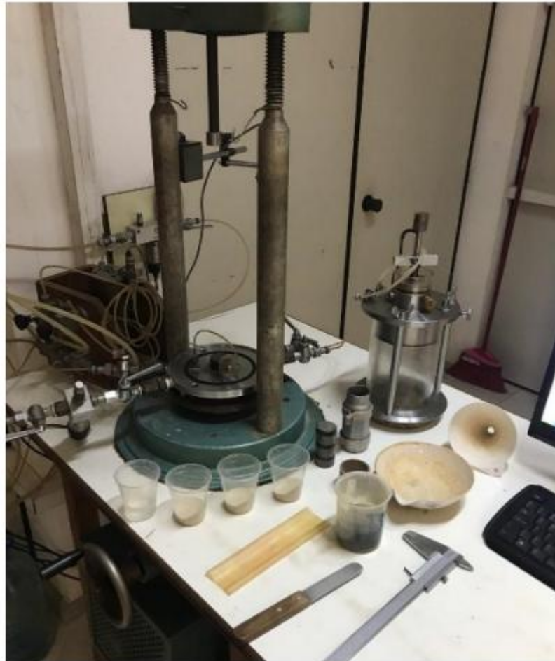
Figura 20: Equipamentos e materiais utilizados na moldagem do corpo de prova
