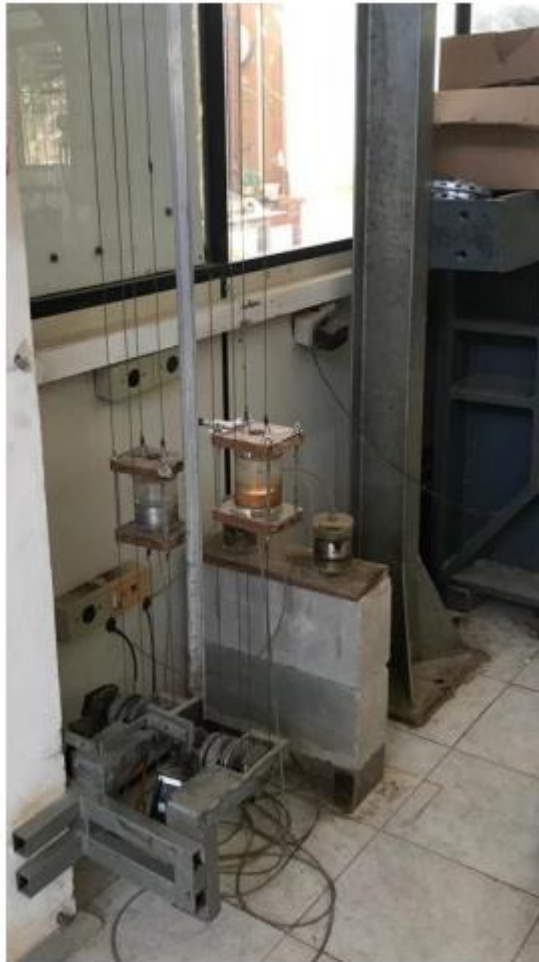
Figura 18: Coluna de mercúrio e servo-motores do sistema hidráulico
