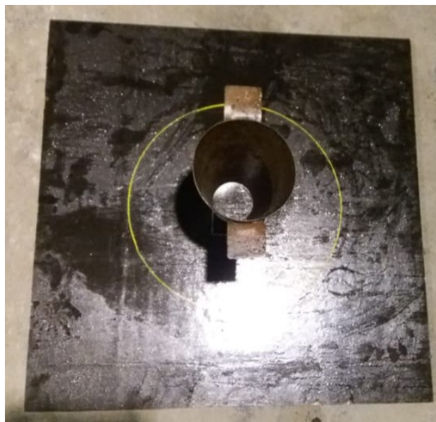
Figura 16 – Determinação do espalhamento do concreto autoadensável com diferentes teores de adição de fibras de aço e polipropileno
