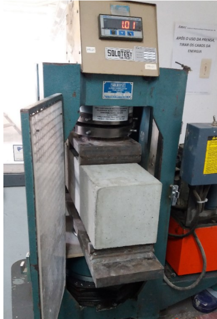
Figura 24 – Ensaio de tração na flexão em corpos de prova prismáticos de concreto
