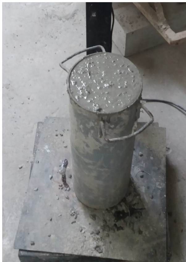
Figura 22 – Determinação de propriedades físicas do concreto autoadensável com diferentes teores de adição de fibras de aço e polipropileno pelo método gravimétrico
