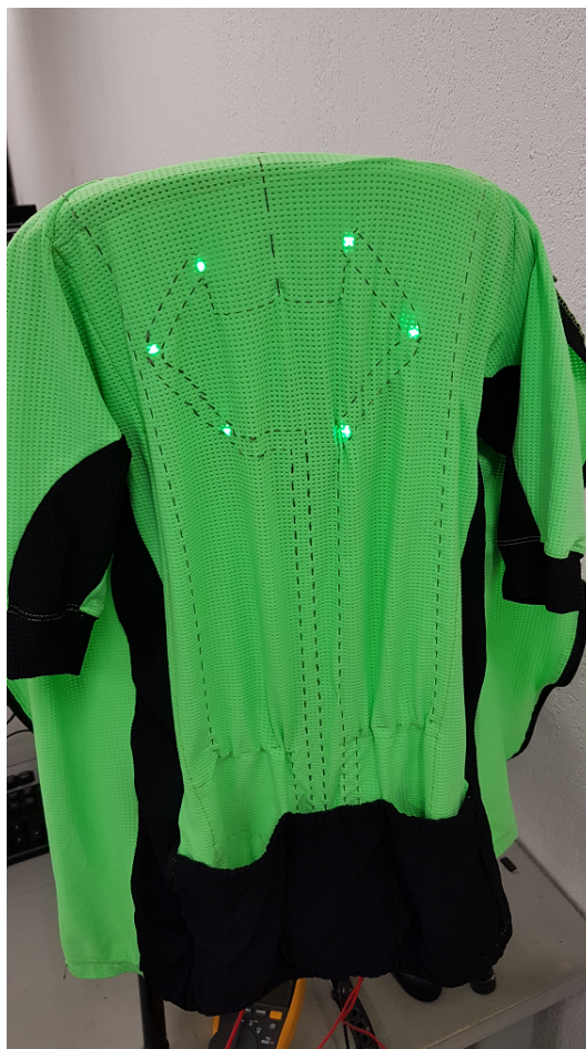
Figura 40 – Costura da linha condutiva realizada manualmente com agulha.
