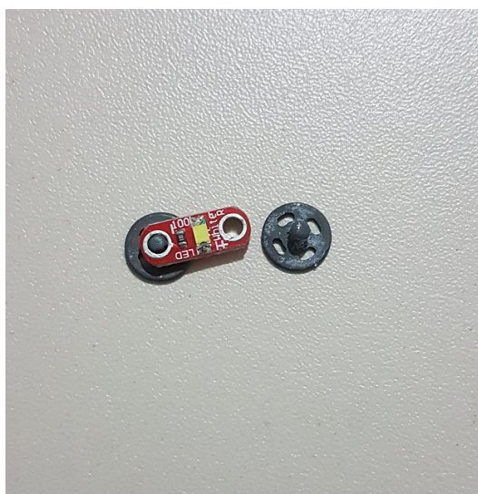
Figura 47 – Detalhe do encaixe do LED no colchete.
