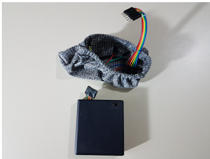
Figura 50 – Encaixe do Módulo no tecido do Conjunto de Bateria.
