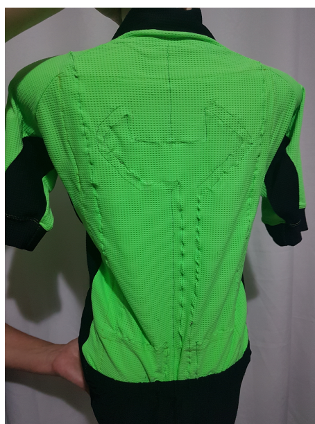
Figura 41 – Costura da linha condutiva realizada através de máquina industrial.
