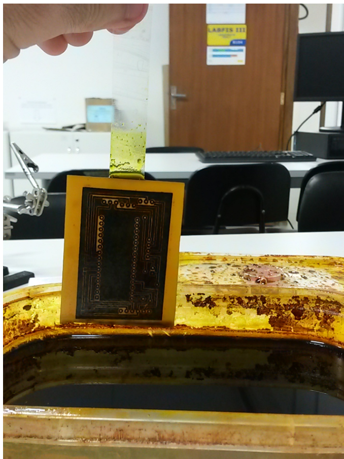
Figura 35 – PCB sofrendo o processo de corrosão.
