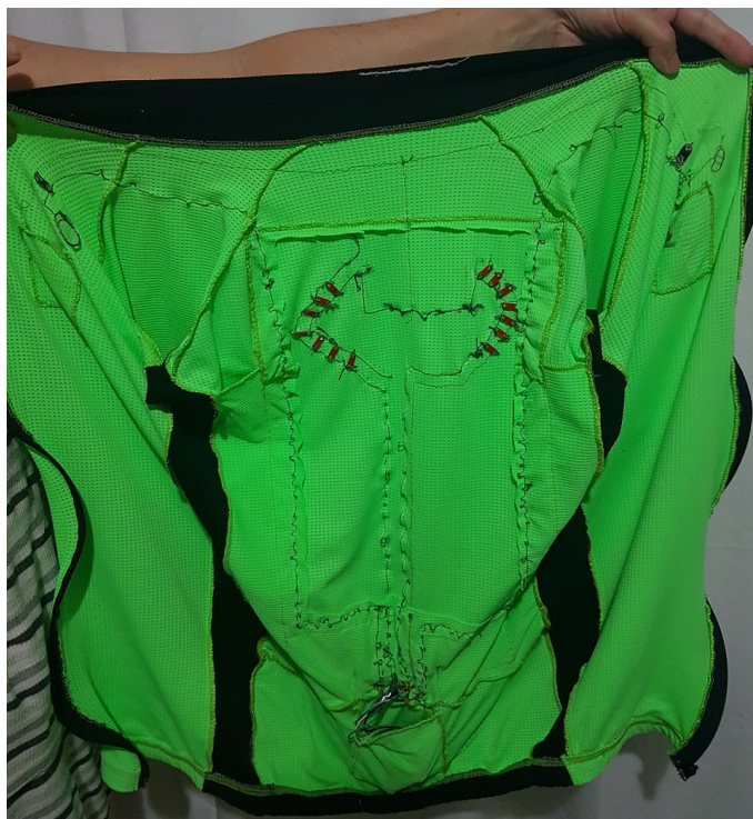
Figura 42 – LEDS presos juntamente com a Camisa.
