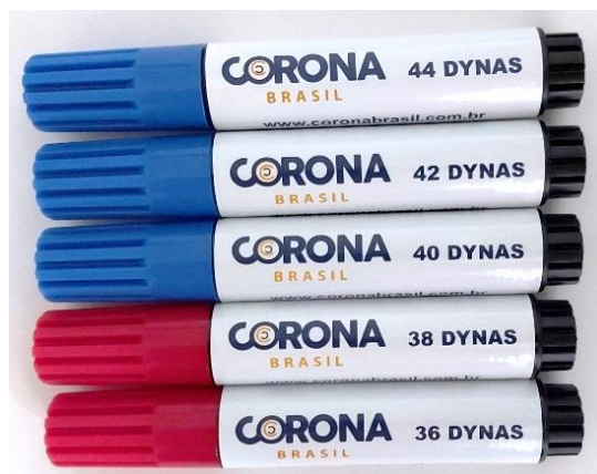
Figura 16 - Canetas utilizadas para determinação da energia superficial dos filmes.
