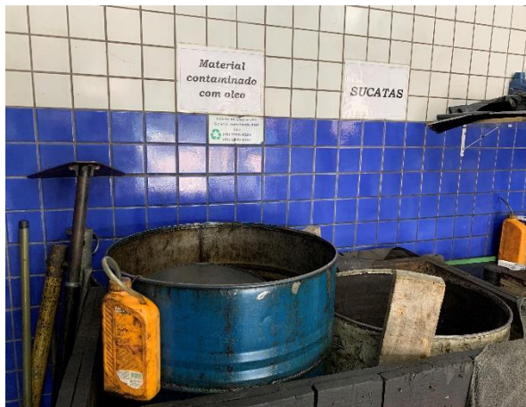
Figura 27 – Tambor de armazenamento de OLUC na oficina
