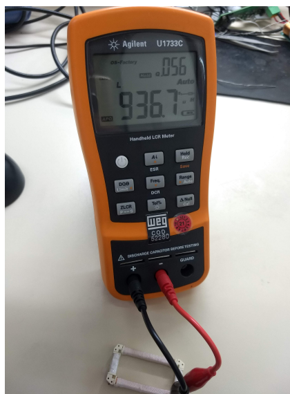
Figura 17 – Ponte RLC utilizada para medição da indutância e resistência da bobina
