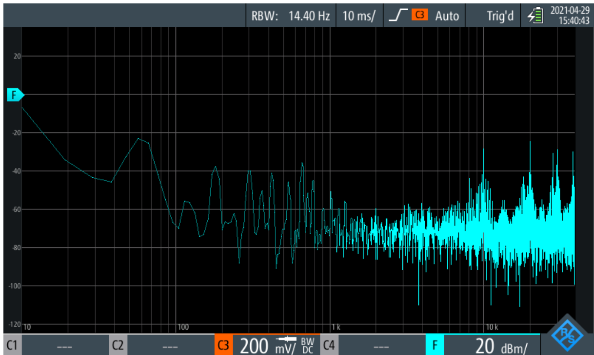
Figura 22 – Gráfico do espectro da frequência do sinal gerado nas bobinas de Rogowski
