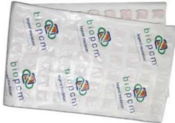
Figura 12 – Manta de material de mudança de fase
