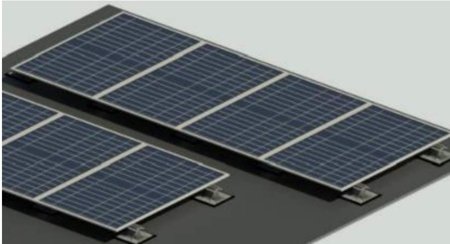
Figura 7 – Detalhe dos painéis fotovoltaicos integrados à edificação
