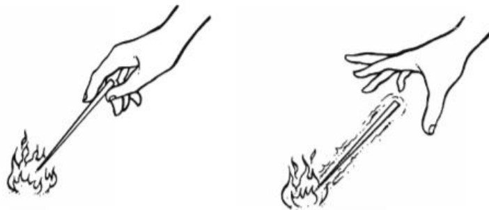
Figura 6 – Transmissão de calor por condução
