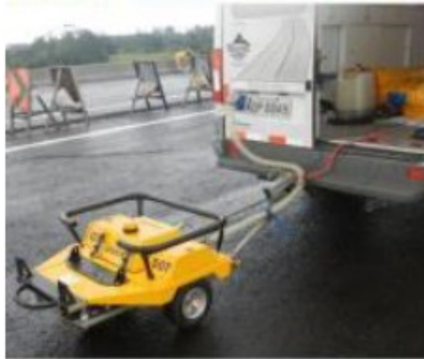
Figura 28 - Griptester movido por veículo genérico adaptado.
