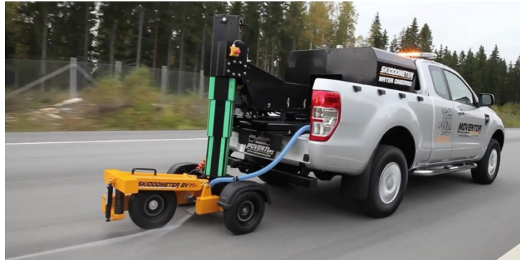
Figura 31 - BV-11 em operação rebocado por pickup média.
