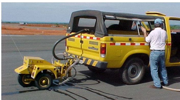
Figura 20 - Mu-meter montado no veículo rebocador pronto para o início do teste.
