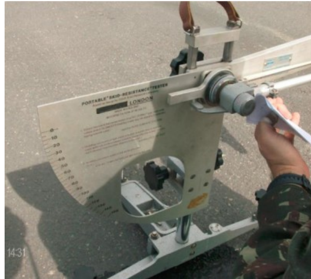
Figura 17 - Levantamento do atrito com Pêndulo Britânico.
