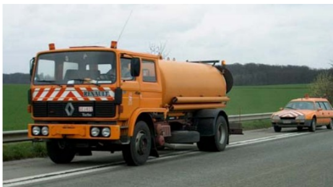
Figura 22 - Odoliograph seguindo caminhão-cisterna.
