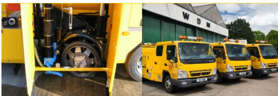
Figura 23 - Montagem da roda a 20° e equipamentos SCRIM.
