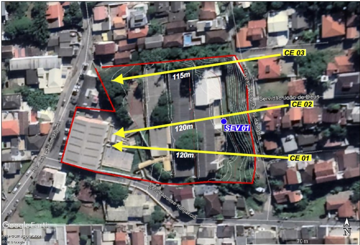
Figura 50: Imagem com a localização dos ensaios caminhamentos geofísicos.
