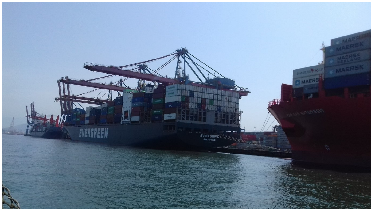
Figura 34 - Navio do armador Evergreen atracado em um dos berços do terminal Santos Brasil, 3 portêineres da marca chinesa ZPMC movimentam contêineres no navio
