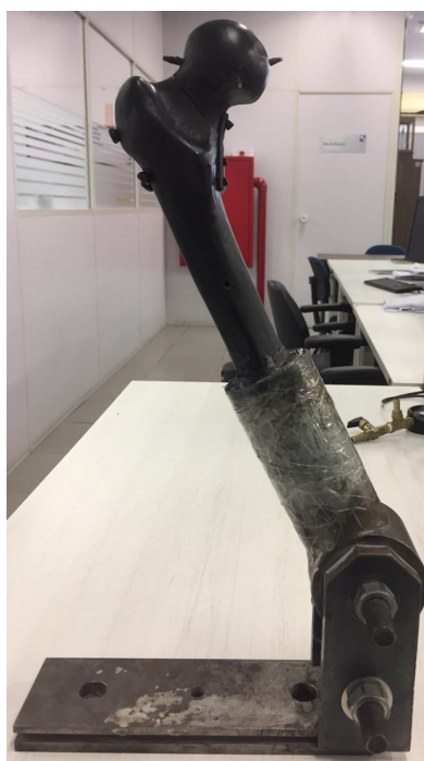
Figura 63 – Modelo físico a ser ensaiado, representado pela montagem do conjunto osso-implante no dispositivo de fixação.
