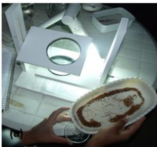
Figura 6: Lupa para visualização de raízes desenvolvida por Marcelo de Sá Amaral (a) e grade quadriculada para contagem da interceptação das raízes nas linhas divisórias (b).
