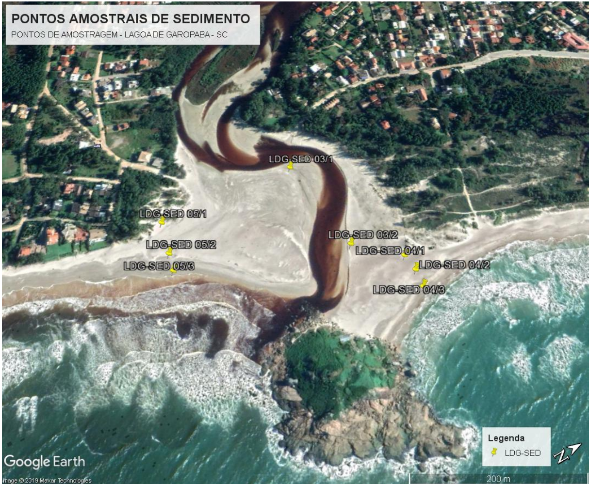
Figura 4. Amostras de sedimentos coletadas na área de desembocadura da lagoa, entre as Praias da Barra, Ferrugem e Morro do Índio.
