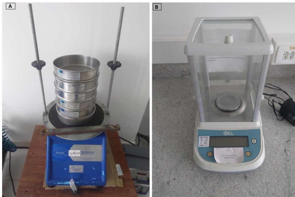
Figura 8. Equipamentos utilizados durante o método do peneiramento. A. Conjunto de peneiras e vibrador eletromagnético. B. Balança de precisão.
