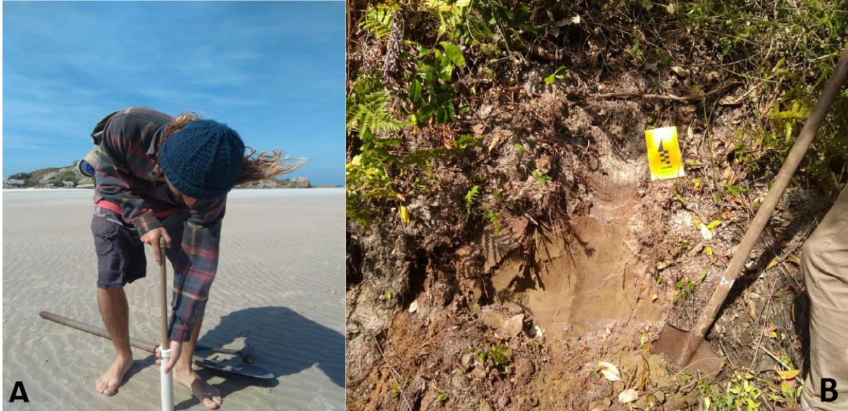
Figura 5 Exemplo de materiais usados na coleta de sedimentos durante o trabalho de campo; A. furador de areia. B. pá de jardinagem.
