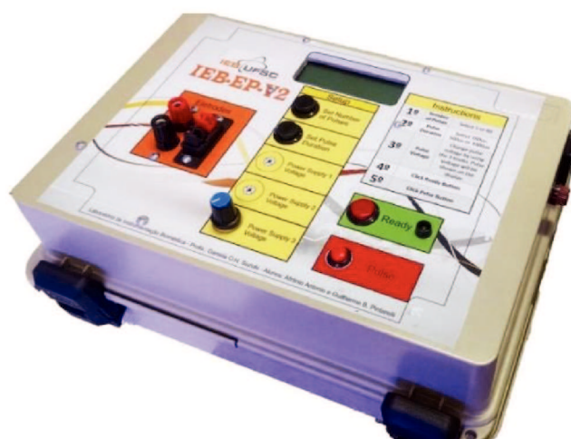
Figura 3.3 – Equipamento eletroporador desenvolvido no IEB
