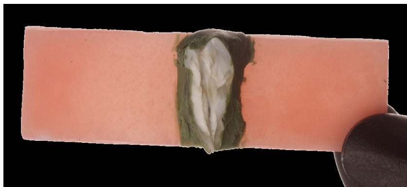
Figura 1. Demonstração da fixação da amostra para o corte, com godiva de alta fusão em uma placa de resina acrílica.
