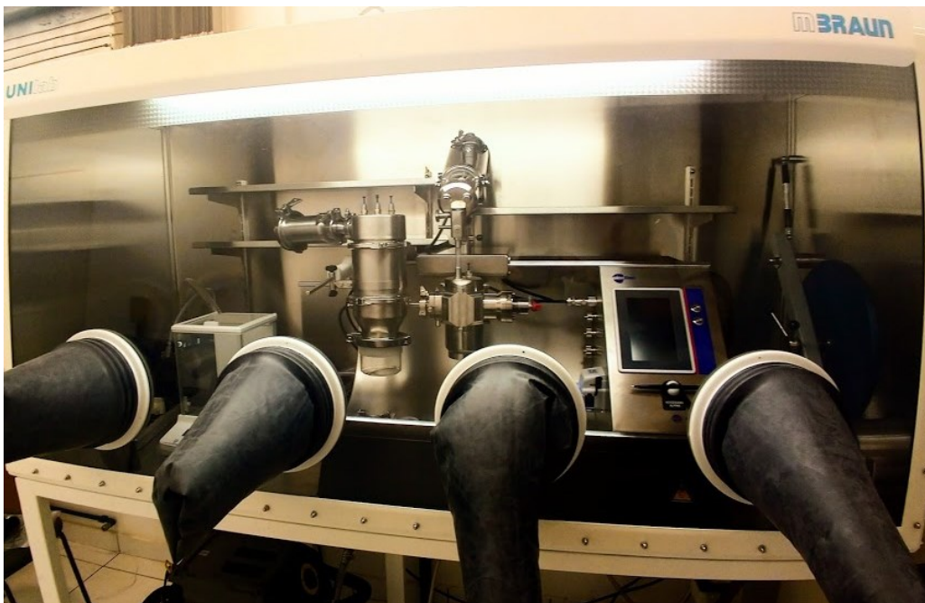
Figura 19 – Sistema de moinho de jatos opostos Pico Jet instalada no interior de câmara anaeróbica UniLab produzido pela MBraun.
