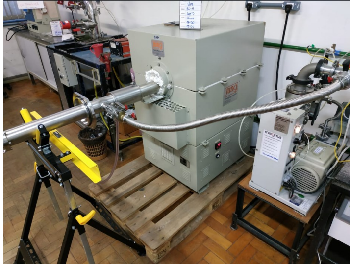
Figura 18 – Sistema para decrepitação por hidrogênio com retorta conectada a um sistema de vácuo e acoplada em forno tubular.
