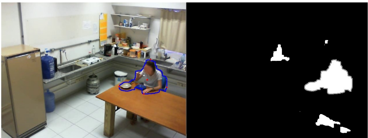
Figura 43 - Resultado da remoção de ruídos utilizando a técnica "fechamento", para a atividade “comer”.
