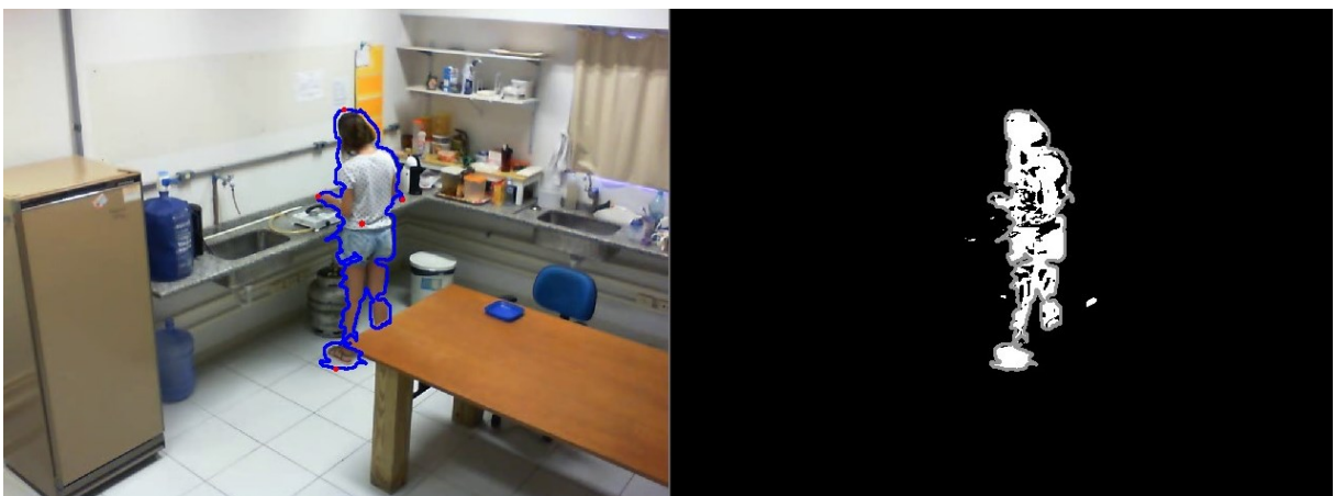
Figura 41 – Frame com o resultado da subtração de fundo utilizando SSIM para a atividade "cozinhar"
