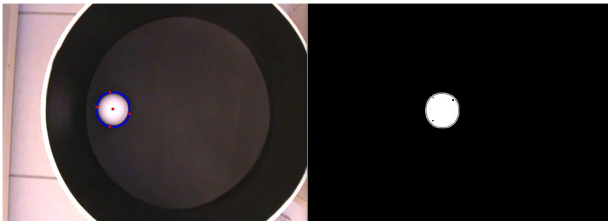
Figura 36 - Extração de fundo com detecção do contorno do objeto
