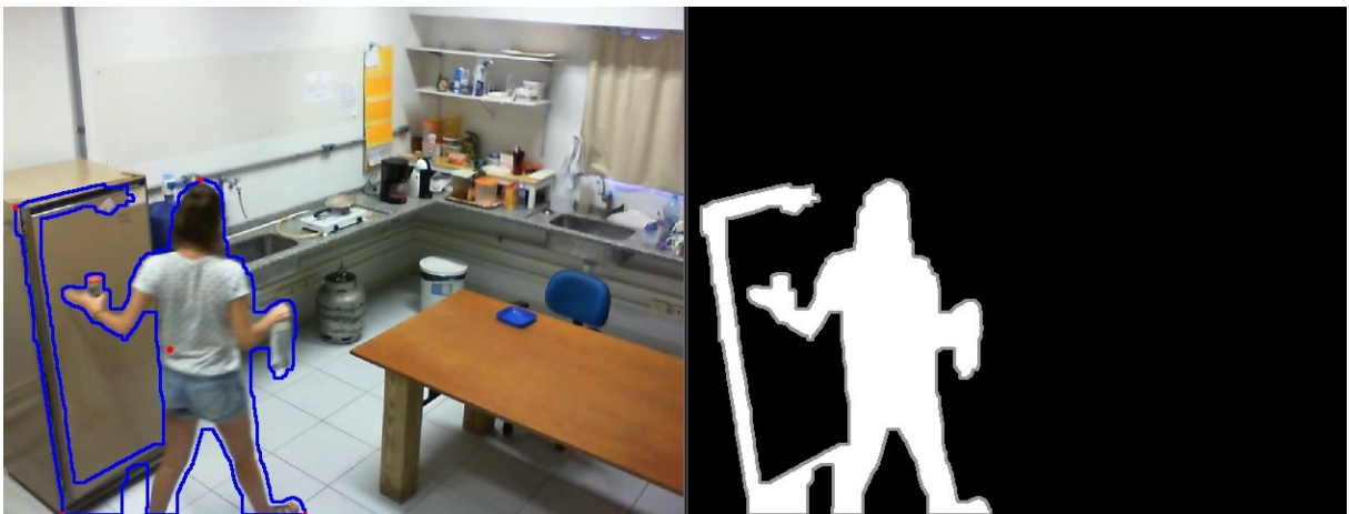
Figura 46 - Resultado da remoção de ruídos utilizando a técnica "fechamento" para a atividade "abrir\fechar geladeira".
